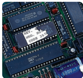
Разрушаемый полиолефин контроля вскрытия (В-410) ломается при попытке вскрытия
